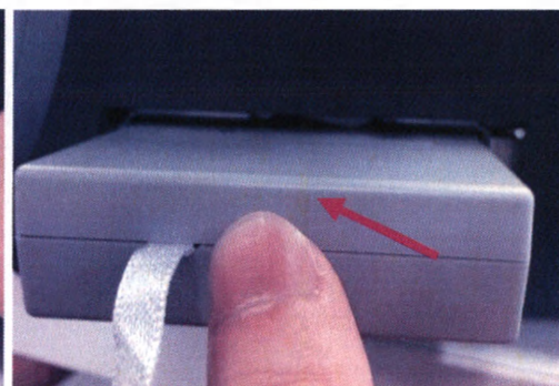
④ Втолкните батарею на место
