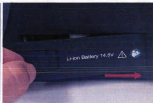
② Вытащите дверцу батарейного отсека
