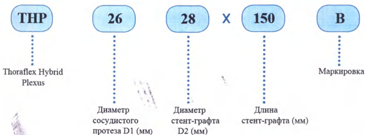
Рисунок 15 – Расшифровка каталожного номера гибридного стент-графта Thoraflex Hybrid различных размеров на системе доставки для протезирования грудной аорты вариант исполнения с 4 браншами.
