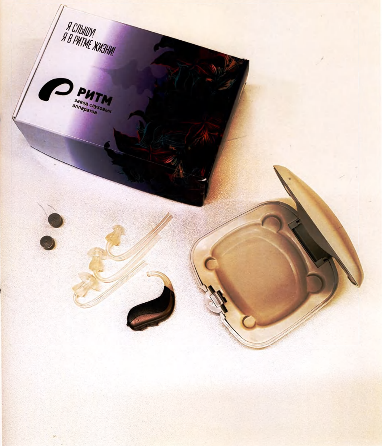
ФОТОГРАФИЯ Аппарата слухового электронные цифрового бесканального программируемого воздушного звукопроводения заушного типа "ВЕРОНА-9" в составе: звукопровод №1, №2, №3; элемент питания 1,4 В, ТИП 13; футляр; коробка.
