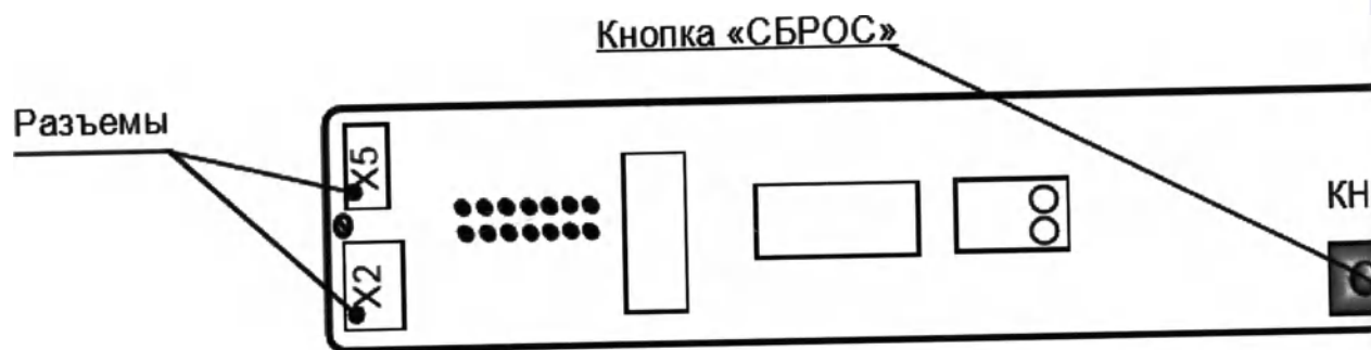
Рисунок 4.4 – схема расположения кнопки обнуления счётчика
