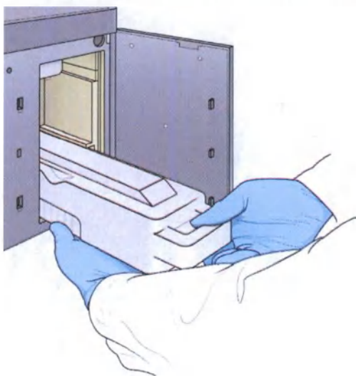
Рисунок 13. Извлечение контейнера с израсходованными реагентами
