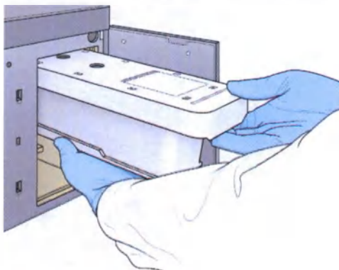
Рисунок 15. Загрузка картриджа с буфером
