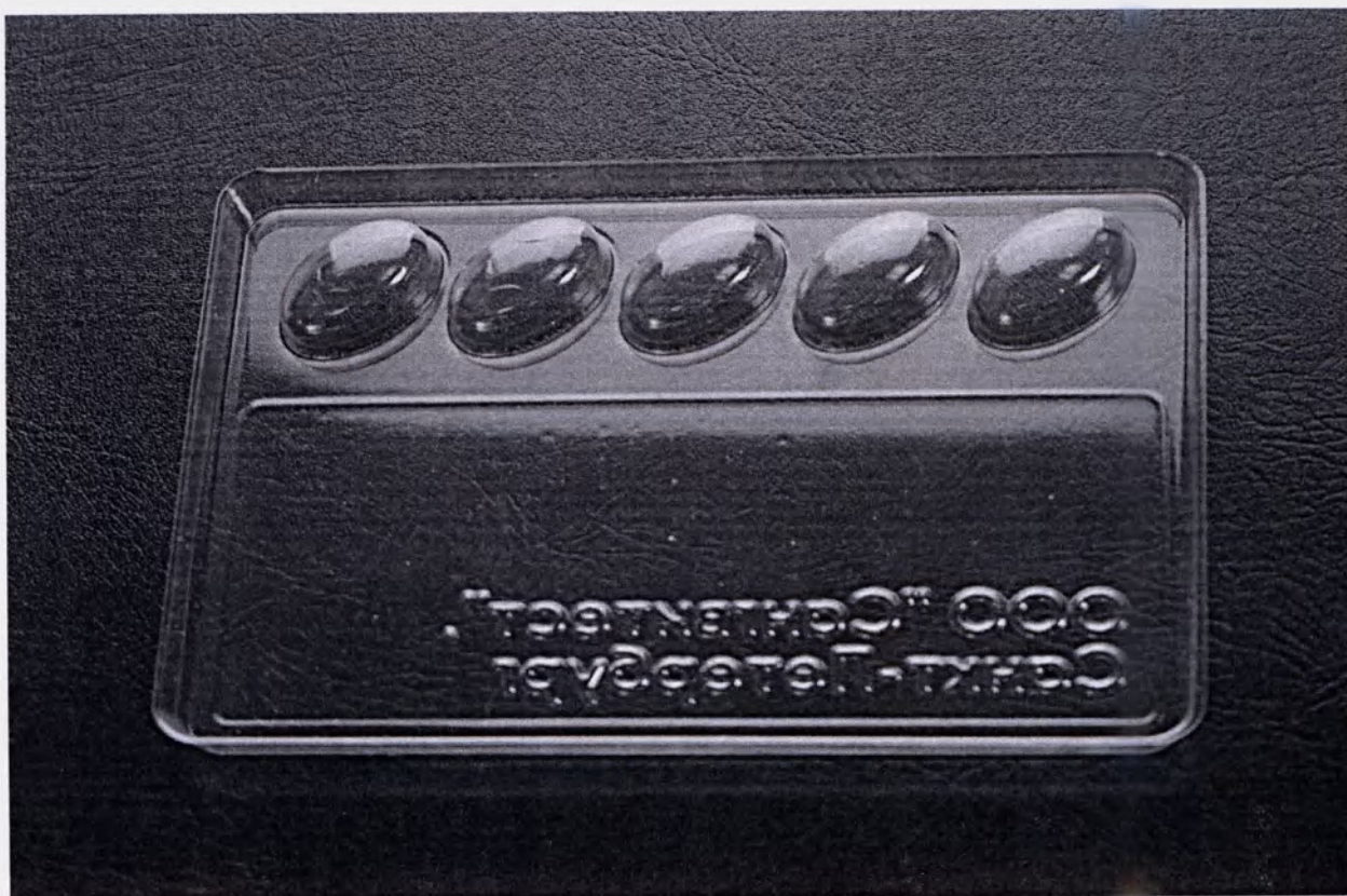
«Планшет для типирования крови человека по антигенам эритроцитов» по ТУ 32.50.13-001-06125010-2017 в варианте исполнения на 5 лунок, прозрачный (вид с тыльной стороны)
