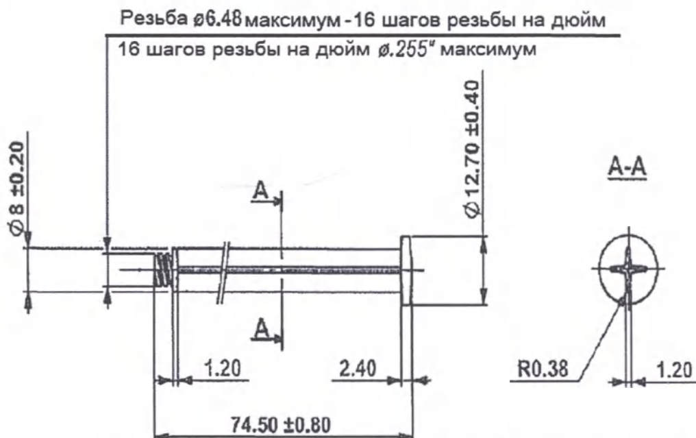
Рисунок 6 – Конструкция штока поршня (шприц 3,0 мл)
