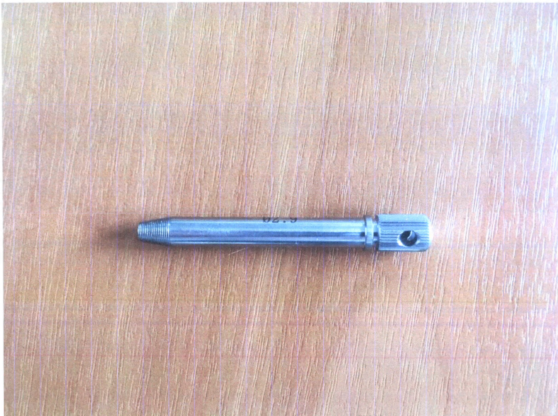
6. Внешний вид направителя сверла (19910050, 19912090, 19913090)
