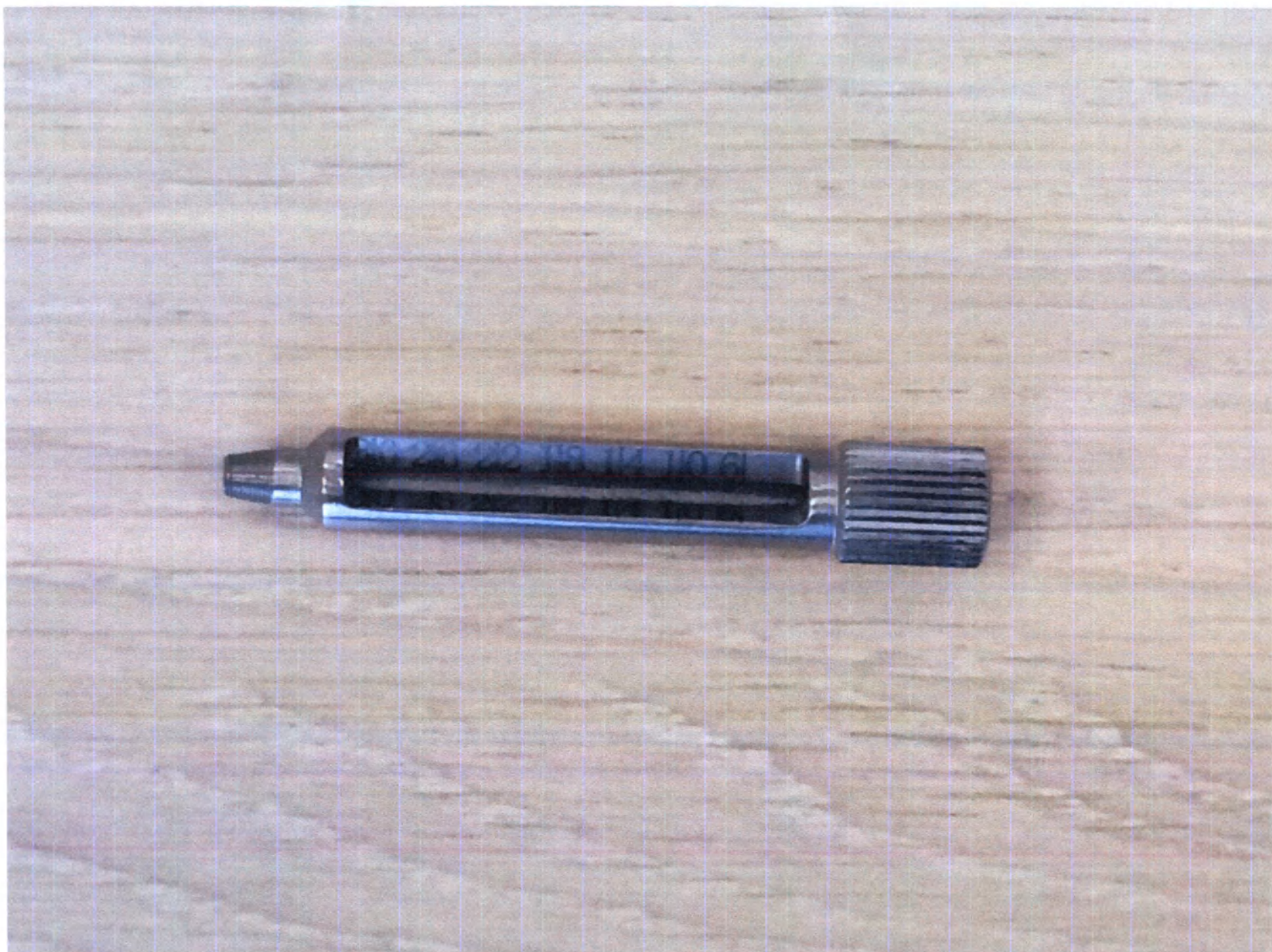
7. Внешний вид направителя сверла (19910060, 19911080, 19911090)
