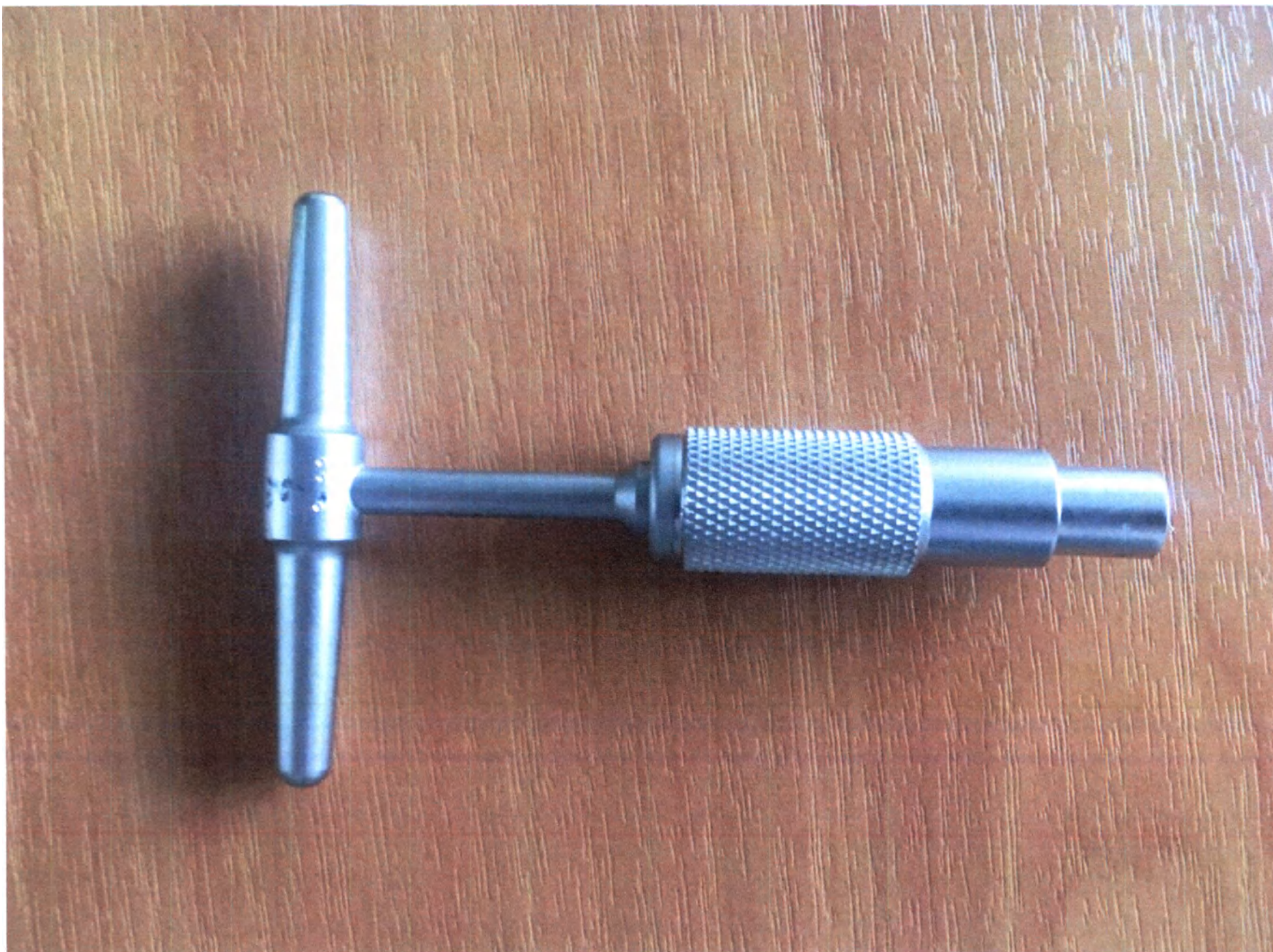
31. Внешний вид рукоятки с быстрым соединением 19912270
