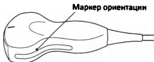
Рис. 6 Ориентация датчика (на рисунке представлена модель датчика C6-2)
