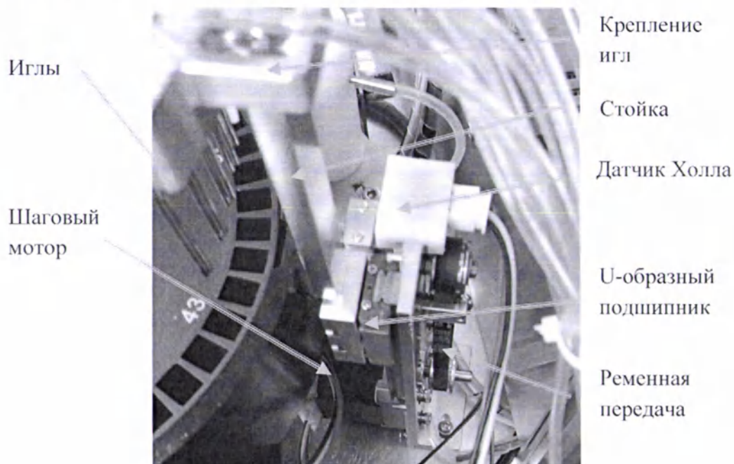
Рис. 6-25. Устройство промывочной станции
