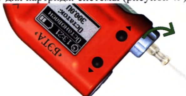
Рисунок 49 – Установка крышки для картридж-системы на корпус помпы
