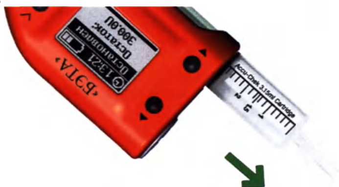
Рисунок 44 – Удаление картридж-системы из помпы
