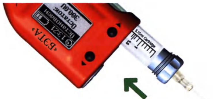
Рисунок 48 – Установка картридж-системы в помпу
