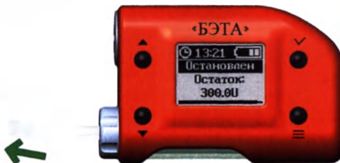
Рисунок 42 – Отсоединение магистрального набора (катетера) инфузионного набора от картридж-системы
