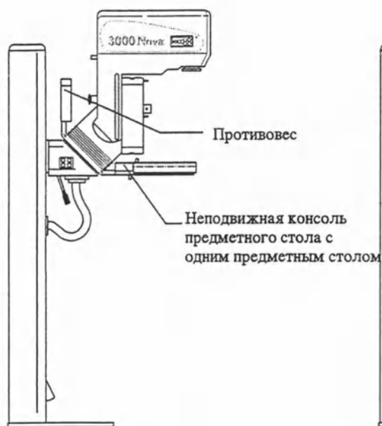
Рисунок 4. Стойка с неподвижной консолью предметного стола
