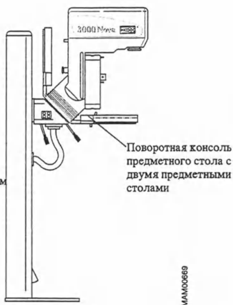
Рисунок 5. Стойка с поворотной консолью предметного стола
