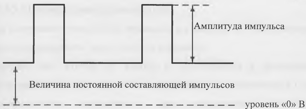
Рисунок 4.3 Форма выходного напряжения при регулировании ДПС
