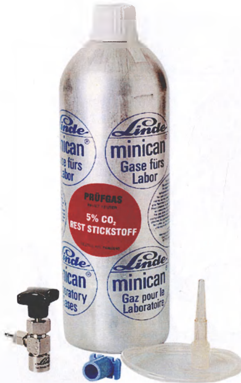
Калибровочный набор для CO 2 (с баллоном для калибровочного газа): 1. Баллон с тестовым газом. 2. Тестовая кювета для датчика CO 2 . 3. Соединительный шланг.
