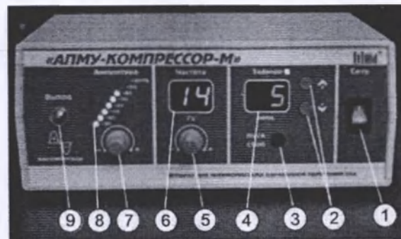
Рис.2. Передняя панель блока коммутации и питания аппарата: 1 - сетевой переключатель; 2 – кнопки для установки времени процедуры; 3 - кнопка "ПУСК/СТОП" для запуска процедуры и ее принудительной остановки; 4 - цифровое табло величины времени процедуры; 5 - регулятор "АМПЛИТУДА" для регулировки амплитуды бароимпульсов; 6 - цифровое табло величины частоты бароимпульсов; 7 - регулятор "ЧАСТОТА" для регулировки частоты следования бароимпульсов; 8 – индикаторы установки амплитуды бароимпульсов; 9 - выходной штуцер для подсоединения трубки с наконечником
