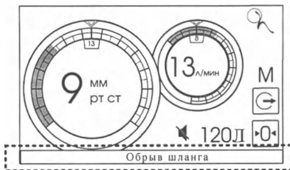
Рис. 19б Аналоговый вид расположения индикатора предупреждений и неисправностей.
