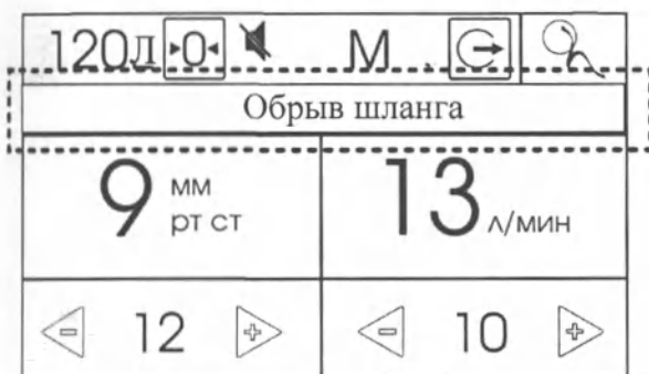
Рис. 19а Цифровой вид расположения индикатора предупреждений и неисправностей.
