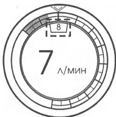
Рис. 11а Постоянная индикация текущей величины допустимого максимального потока в аналоговом виде отображения.
