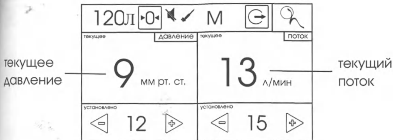
Рис.12 Индикация текущих значений в цифровом виде.
