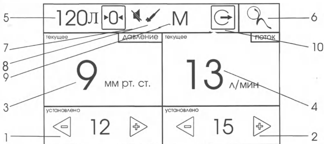
Рис. 6б Цифровой вид отображения ГЭ ГИ.
