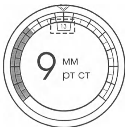
Рис. 9а Постоянная индикация текущего значения заданного абдоминального давления в аналоговом виде отображения.
