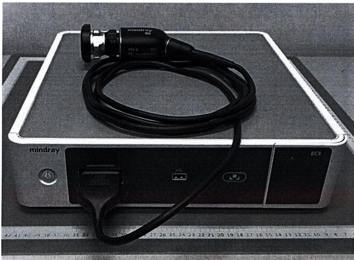
Устройство для обработки видеоизображения ЕС3. Блок основной ЕС3 и головка видеокамеры ЕС3. Общий вид
