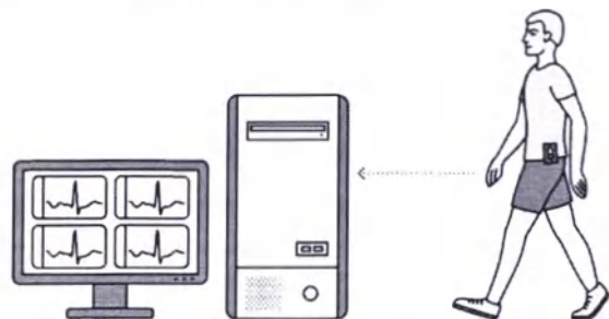
Рис. 3. Функциональная схема работы кардиорегистратора «КР-2» на примере работы с ПК
