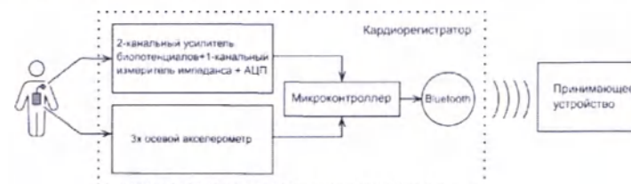
Рис. 2. Схема работы блока кардиорегистратора в режиме передачи данных по сети Bluetooth в принимающее устройство.
