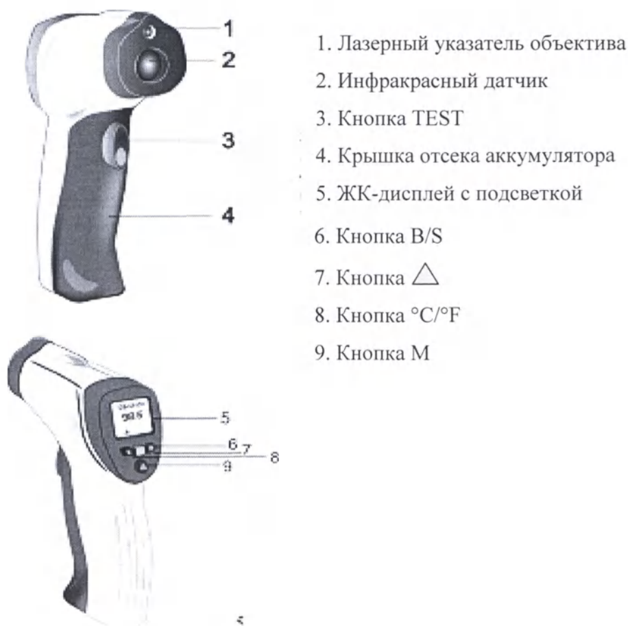
Рис.1 Структура термометра инфракрасного бесконтактного
