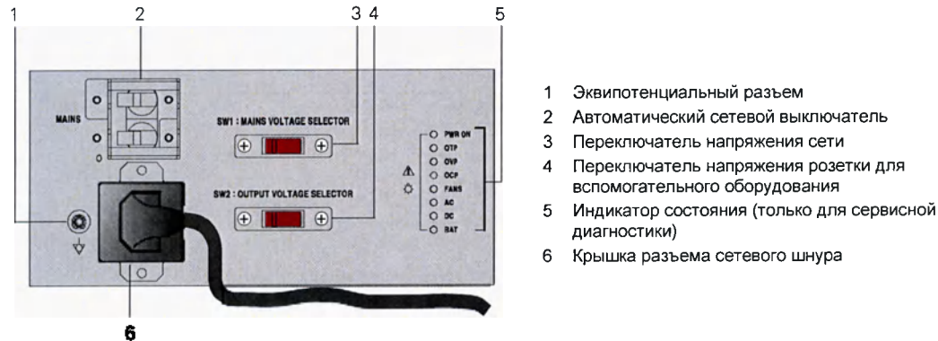
Вид панели электропитания.
