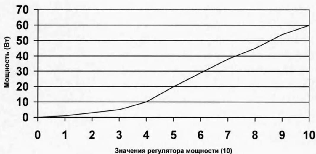
Мощность аппарата Vesalius в режиме "РАЗРЕЗ" (при сопротивлении 1500 Ом)
