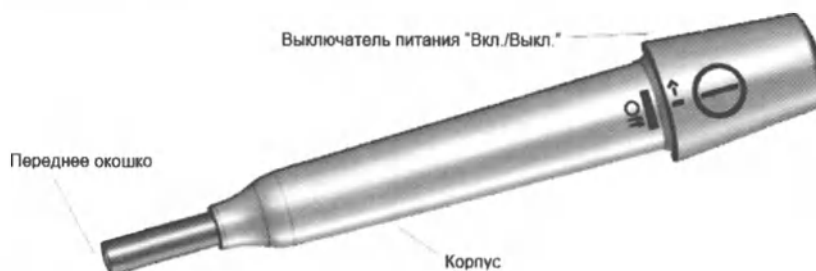
Рисунок 2: Конструкция детектора RadPointer-Beta: переднее окошко, корпус и выключатель питания
