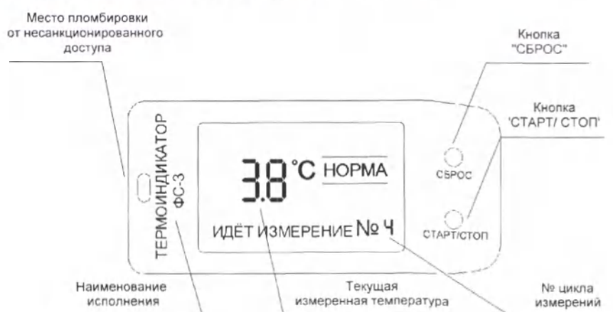
Рисунок 1. Внешний вид лицевой поверхности ТИ ФС-3.
