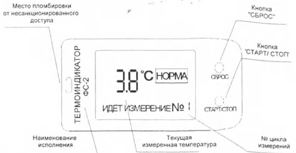
Рисунок 1. Внешний вид лицевой поверхности ТИ ФС-2.
