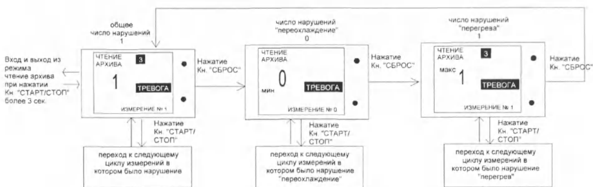
Рисунок 10. Чтение архива нарушений.
