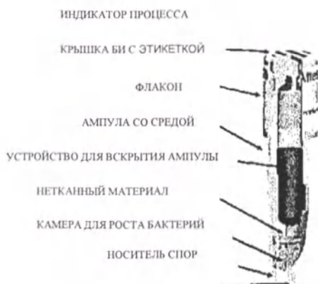
Рисунок 1: Конструкция Биологического индикатора быстрого чтения Attest Rapid Readout
