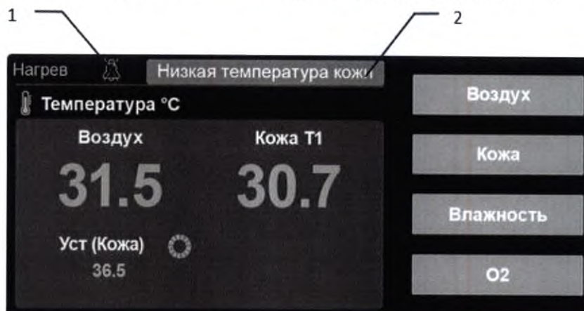
Отображение сообщения аварийной сигнализации:
