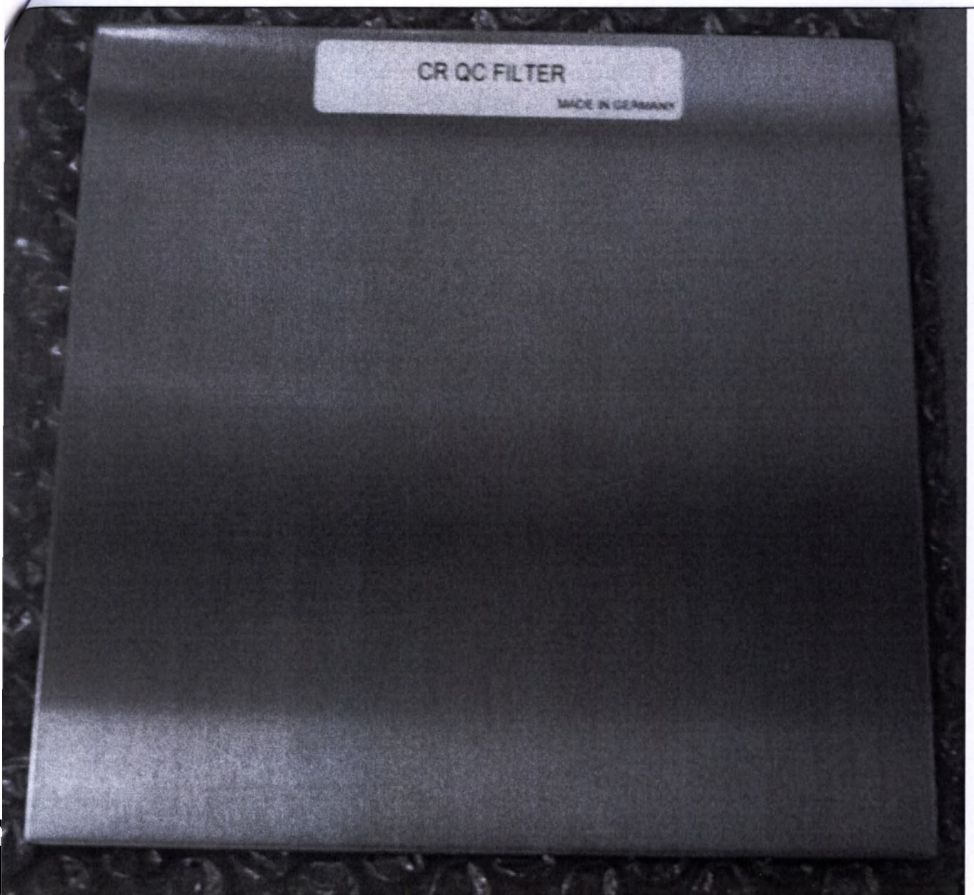
Медный фильтр для калибровки системы.
