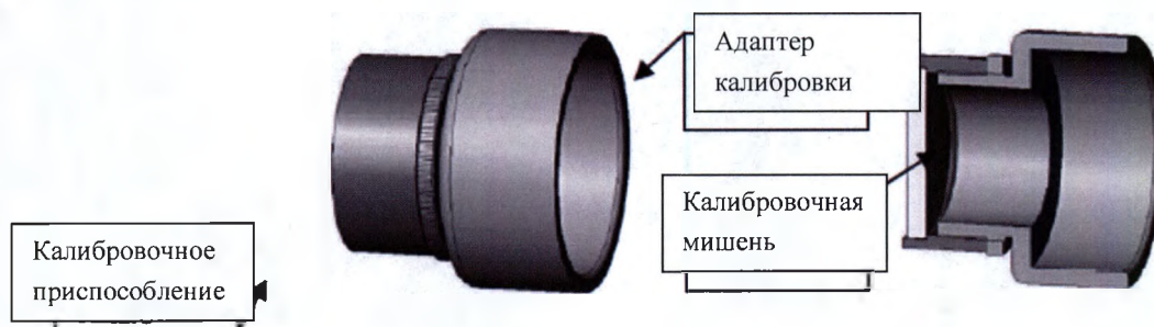
Калибровочное приспособление телецентрической линзы диаметром 25 мм
