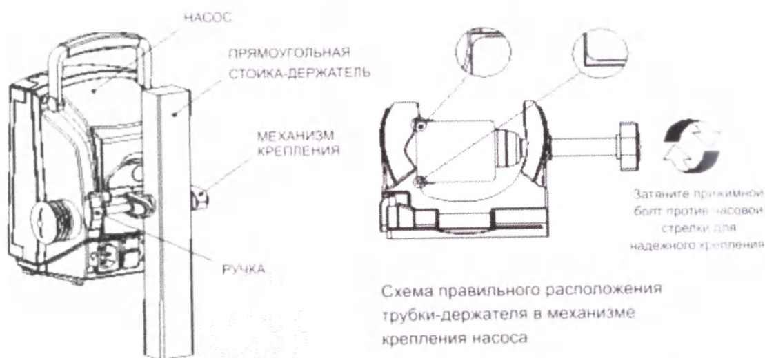
Рисунок 8. Крепление на квадратную стойку насоса волюметрического WIT-601A
