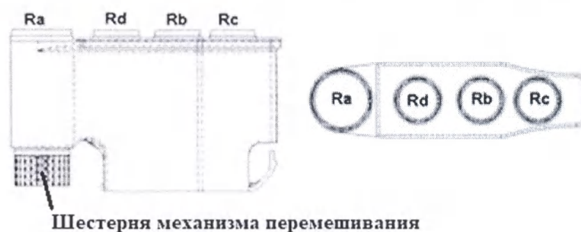
Рис. 4.1 Расположение реагентов в кассете
