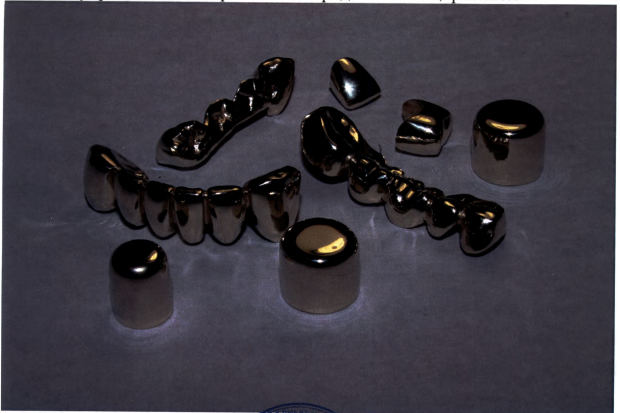
Защитно-упрочняющее покрытие из нитрида титана с цирконием
