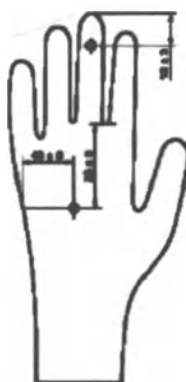
Рисунок 3 - Точки измерения толщины стенки перчатки
