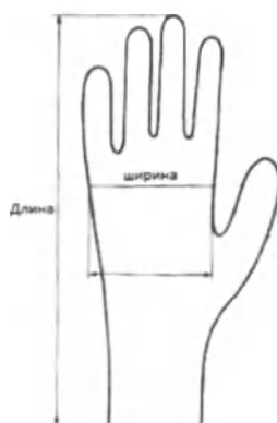
Рисунок 2 – Точки для измерения ширины и длины перчатки
