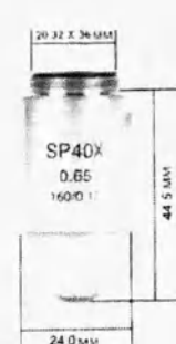
Рисунок 11. Полупланарный ахроматический объектив: 40x (NA 0.65)
