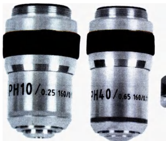
Рис. 31. Насадка PC-2 для наблюдений по методу фазового контраста, с длинным цилиндром ахроматической разномощности объективов 10х и 40х
