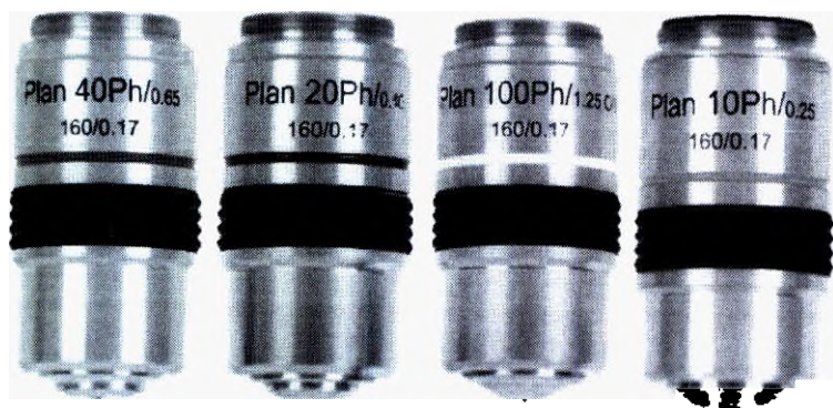
Рис. 32. Насадка PC-4 для наблюдений по методу фазового контраста, с длинным цилиндром ахроматической разномощности объективов 10х, 20х, 40х и 100х с универсальным конденсором
