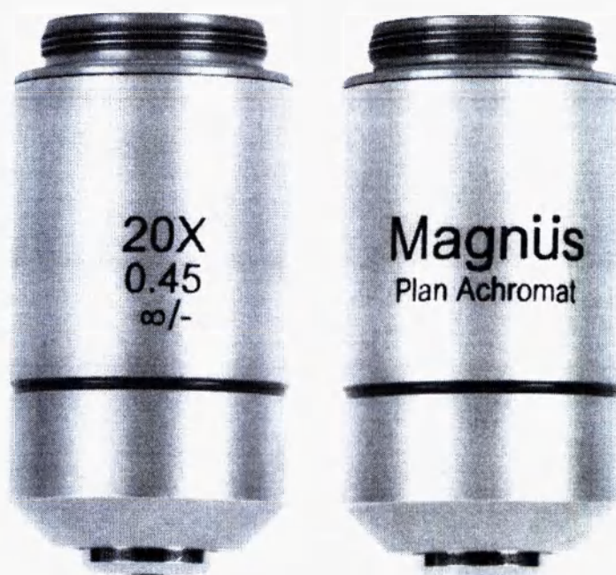
Рис. 12. Планарный ахроматический объектив: 20x (NA 0.45)
