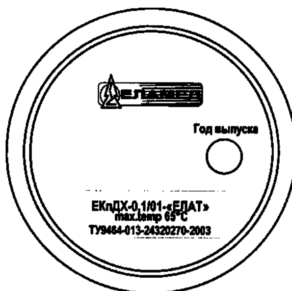
Рисунок 2 – Маркировка на задней поверхности (дне) емкостей-контейнеров из полистирола.
