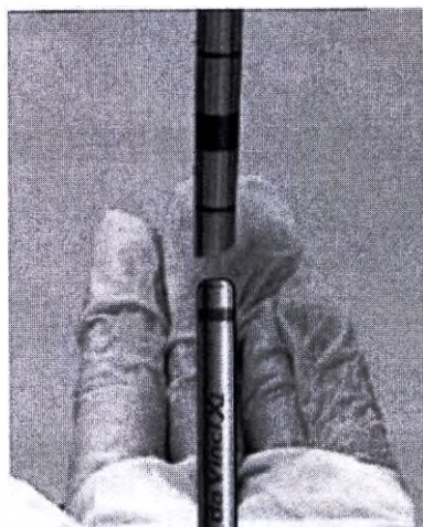
Без повреждений – калибровочный штифт проходит
