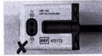
Промывочная трубка смещена, ее не видно в основном промывочном отверстии
