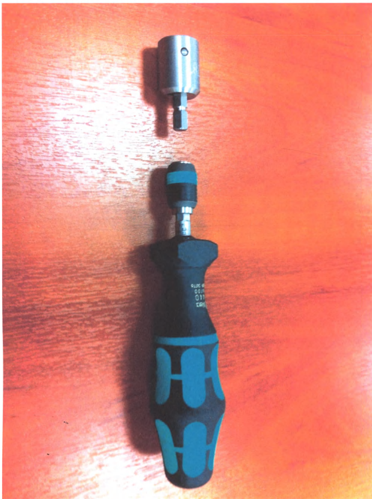
13. Инструмент для снятия и установки крышки турбинного наконечника.
