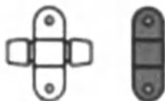
Рисунок 26 - Схематическое изображение фиксирующей муфты.
