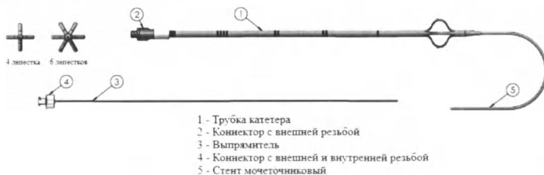
Рисунок 13 – Схематическое изображение катетера Малеко с интегрированным мочеточниковым стентом.
