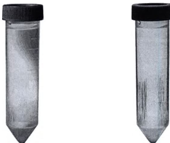
Рис. 8. Примеры пробирок с минимальным и умеренным образованием трещин.
