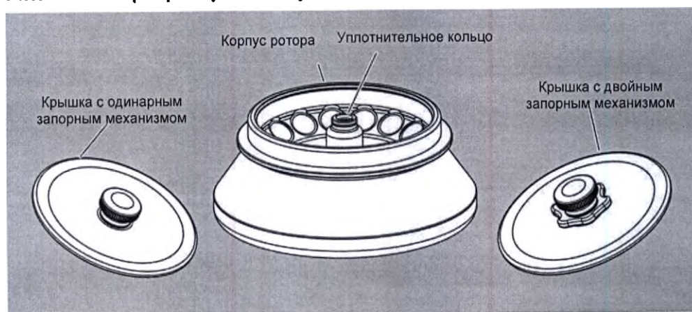
Рис. 1 Ротор с фиксированным углом JA-14.50
