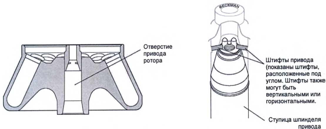
Рис. 1. Расположение и направление штифта привода ротора
