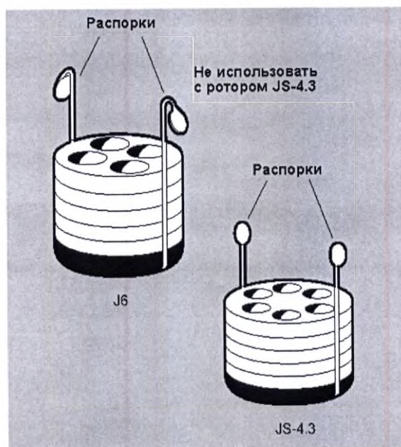
Рисунок 4. Распорки (вертикальные опоры) модульных дисковых адаптеров для ротора JS-4.3 (и GH-3.8) и адаптеров для роторов серии J6 НЕ одинаковы
