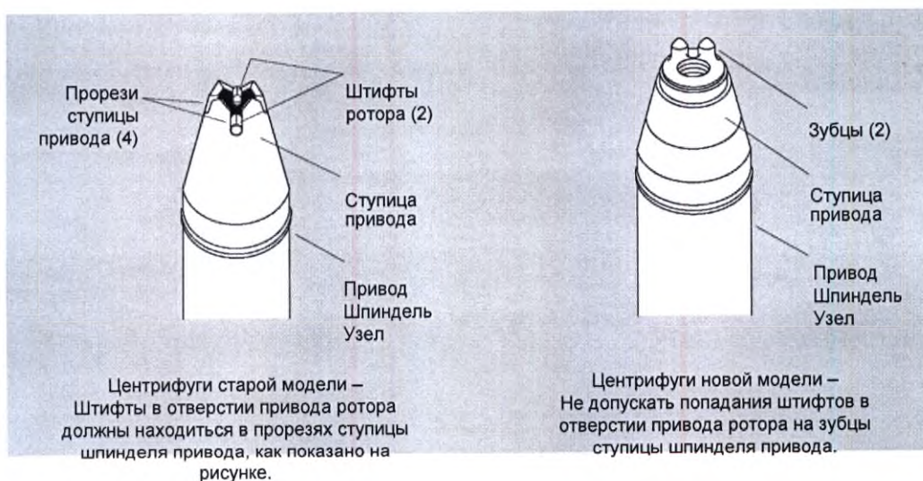
Рис. 3. Конфигурации ступицы привода центрифуги
