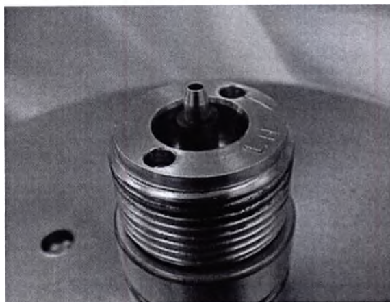
Рисунок А.5. Скошенный конец трубки перекачки
