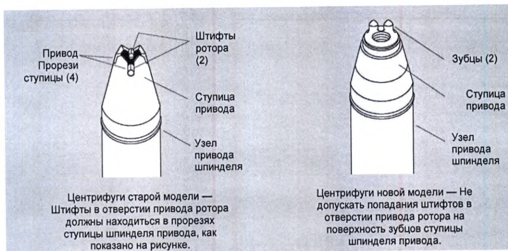
Рис. 2. Конфигурации ступицы привода центрифуги
