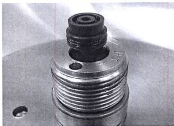
Рисунок А.6. Правильное положение вращающегося уплотнительного узла
