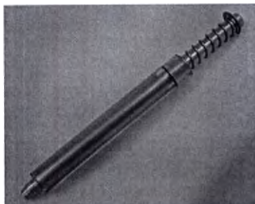
Рисунок А.3. Полностью собранный узел трубки перекачки
