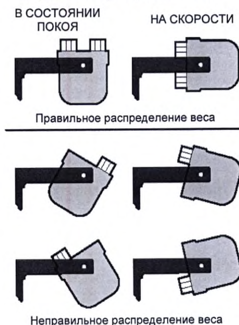
Рисунок 5. Примеры влияния на горизонтальное перемещение бакетов при правильном и неправильном распределении веса
