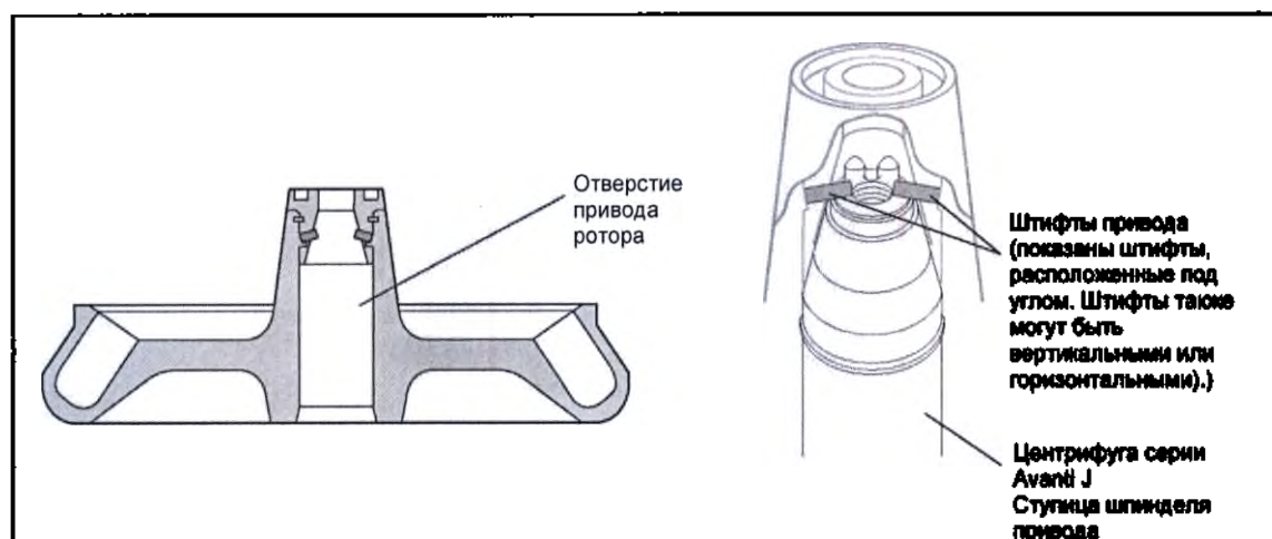
Рис. 2. Расположение и направление штифта привода ротора
