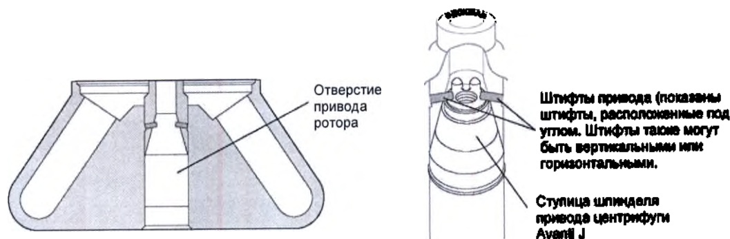
Рис. 1. Расположение и направление штифта привода ротора
