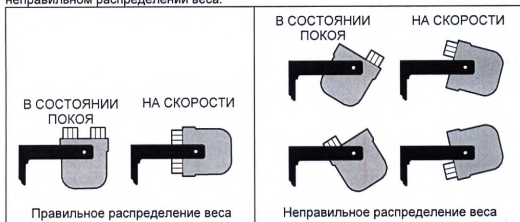
Рис. 6 Примеры влияния на горизонтальное перемещение бакетов при правильном и неправильном распределении веса.
