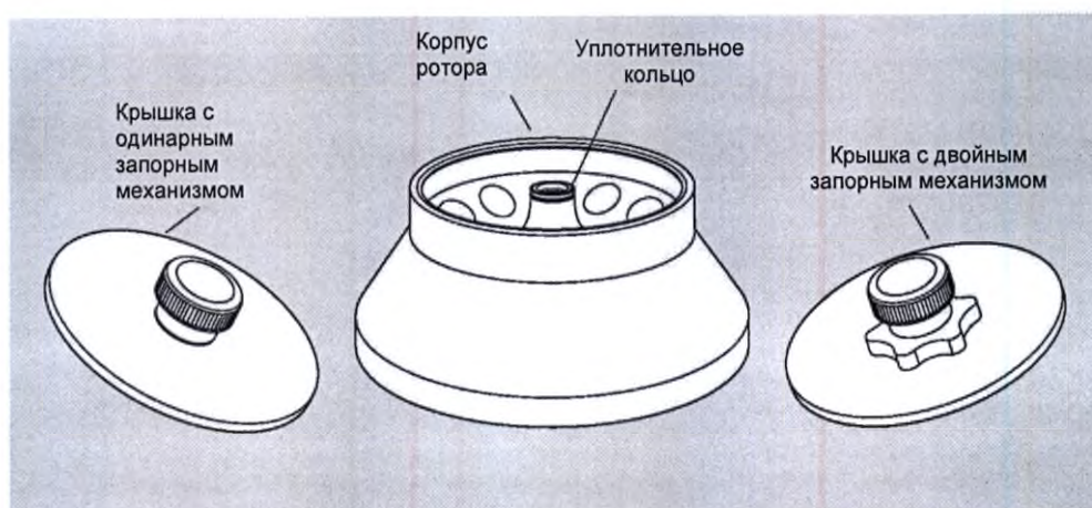
Рис. 1. Угловой ротор JA-12
