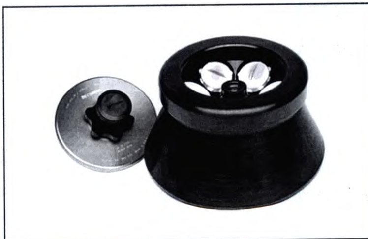
Рис. 1. Угловой ротор JLA-16.250 (показана крышка с двойным запорным механизмом)
