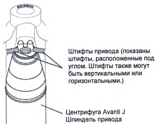
Рис. 2. Направление расположения штифта привода ротора
