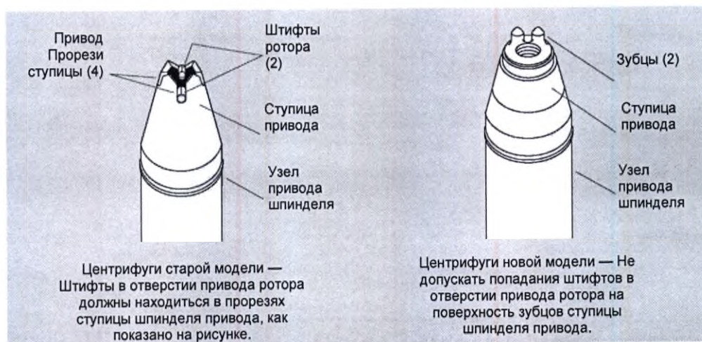
Рис. 3. Конфигурации ступицы шпинделя привода центрифуги
