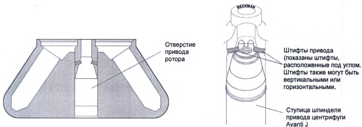
Рис. 2. Расположение и направление штифта привода ротора
