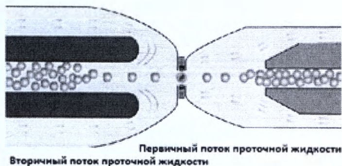
Рис.5 Метод импеданса проточной жидкости
