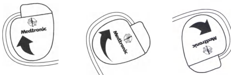
Рисунок 4. Вращение устройства позволяет выбрать излишнюю длину электрода
