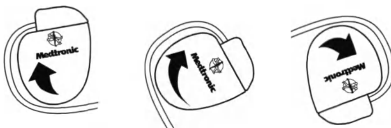
Рисунок 4. Вращение устройства позволяет выбрать излишнюю длину электрода
