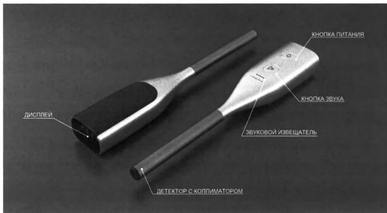
Рисунок 1 – общий вид и органы управления прибора
