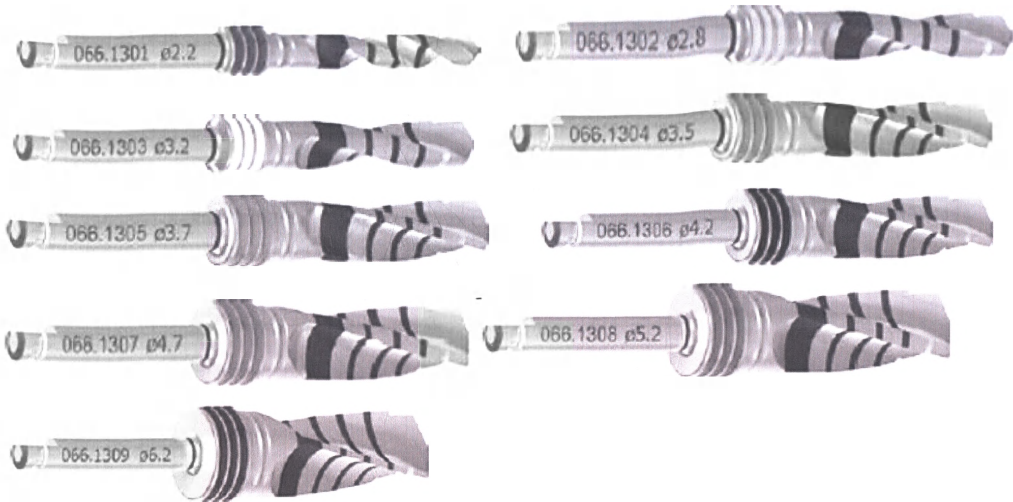
Рисунок 1 – Внешний вид: 1 - Сверло пилотное для направленной хирургии X Pilot VeloDrill, короткое, Ø2.2 мм, 2 - Сверло для направленной хирургии X VeloDrill, короткое, Ø2.8 мм, 3 - Сверло для направленной хирургии X VeloDrill, короткое, Ø3.2 мм, 4 - Сверло для направленной хирургии X VeloDrill, короткое, Ø3.5 мм, 5 - Сверло для направленной хирургии X VeloDrill, короткое, Ø3.7 мм, 6 - Сверло для направленной хирургии X VeloDrill, короткое, Ø4.2 мм, 7 - Сверло для направленной хирургии X VeloDrill, короткое, Ø4.7 мм, 8 - Сверло для направленной хирургии X VeloDrill, короткое, Ø5.2 мм, 9 - Сверло для направленной хирургии X VeloDrill, короткое, Ø6.2 мм.
