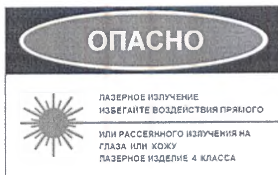
Рисунок 2.1 Предупредительная табличка с пояснениями о лазерном излучении
