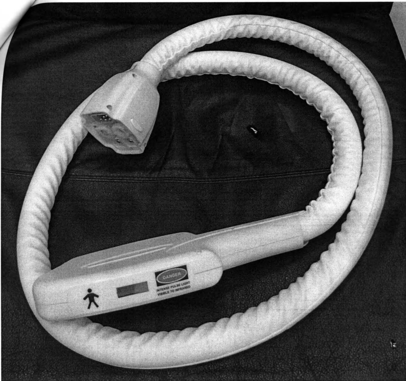
Подключаемая рукоятка IPLASER 500 нм. Общий вид.
