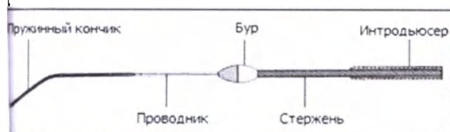
Рисунок 2. Кончик катетера с буром ROTALINK Burr и проводник
