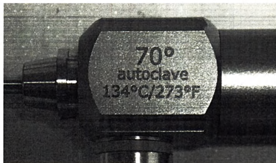
«Эндоскоп Rudolf жесткий», Синускоп, диаметр 2,7 мм, длина 187,5 мм, угол 70°
