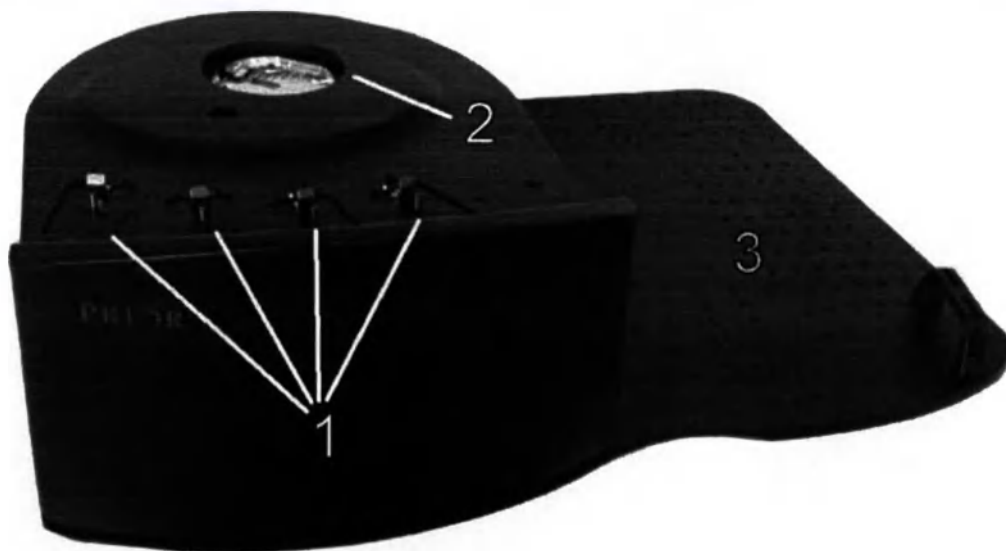
Рисунок 93 - Общий вид основания загрузчика слайдов PL-200. 1 – отсеки кассет для слайдов, 2 – место башенного корпуса PL200, 3 – место установки микроскопа
