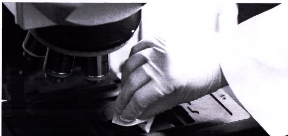
Рисунок 221 - Очистите спиртовой салфеткой фиксирующий механизм держателя слайдов
