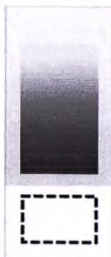
Рисунок 105 - Область нанесения этикетки со штрих-кодом на предметное стекло отмечена пунктиром
