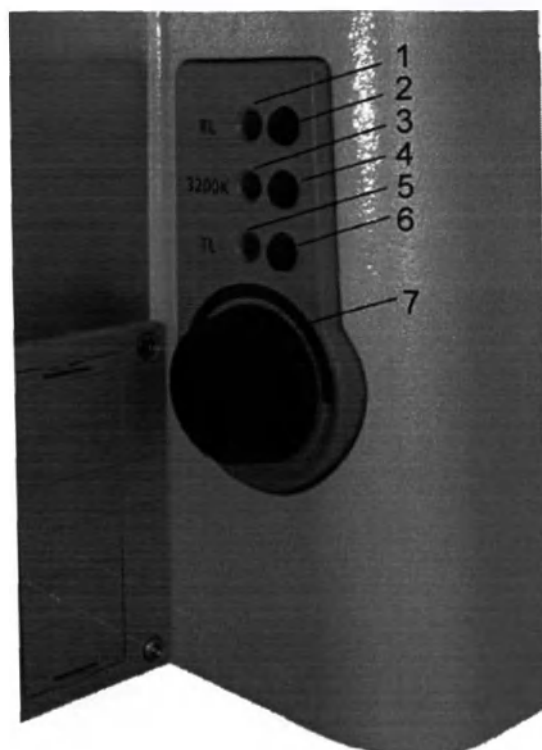
Рисунок 5 - Блок управления светом: 1 – индикатор переключателя затвора отраженного света, 2 – переключатель затвора отраженного света, 3 – индикатор переключателя цветовой температуры на 3200 К, 4 - переключатель цветовой температуры на 3200 К, 5 - индикатор переключателя затвора проходящего света, 6 - переключатель затвора проходящего света, 7 – колесо регулировки интенсивности света
