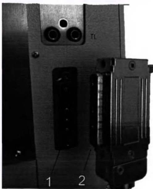
Рисунок 138 - Подключение блока питания к микроскопу: 1 - разъем подключения блока питания на штативе микроскопа, 2 - разъем для подключения к микроскопу блока питания
