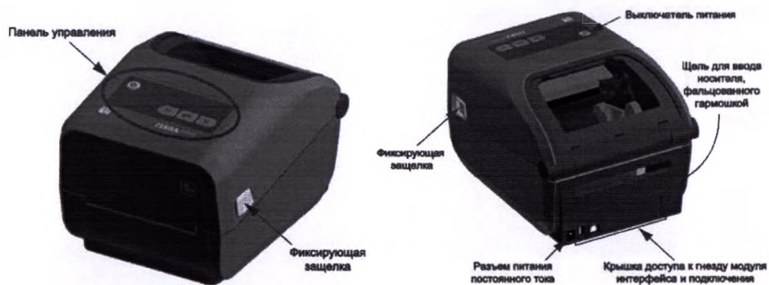
Рисунок 161 - Функциональные элементы V-Printer
