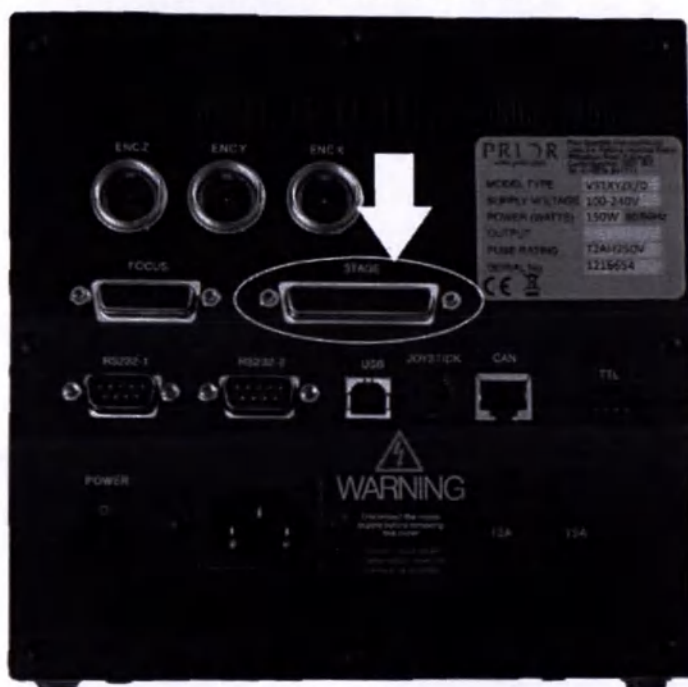
Рисунок 141 - Задняя панель 3-осевого контроллера ProScan III. Стрелкой обозначен разъем подключения кабеля для 2-осевого привода столика
