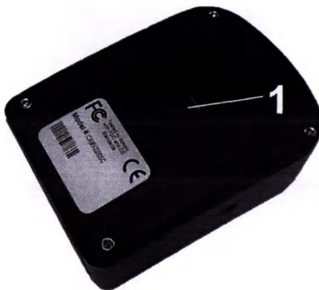
Рисунок 73 - Камера CAM V2200. Вид снизу: 1 - чувствительный элемент
