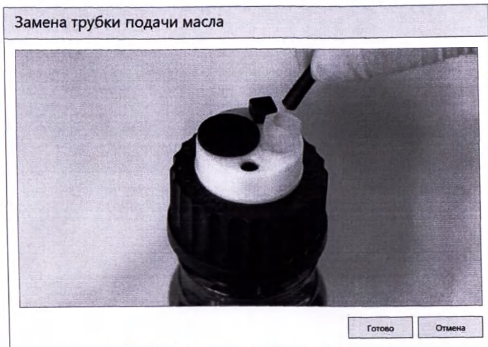
Рисунок 172 - Замена трубки подачи масла
