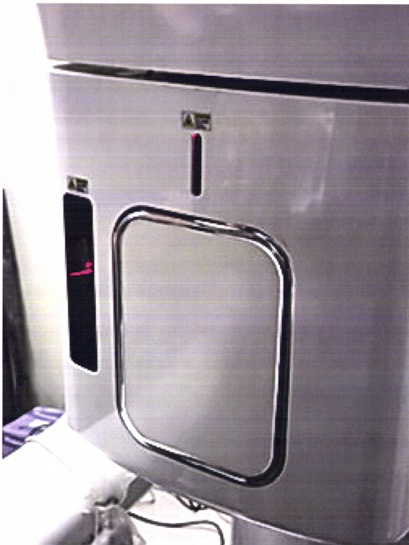
4. Рентгеновский генератор (GEN1 или PXD-120PA на выбор)
