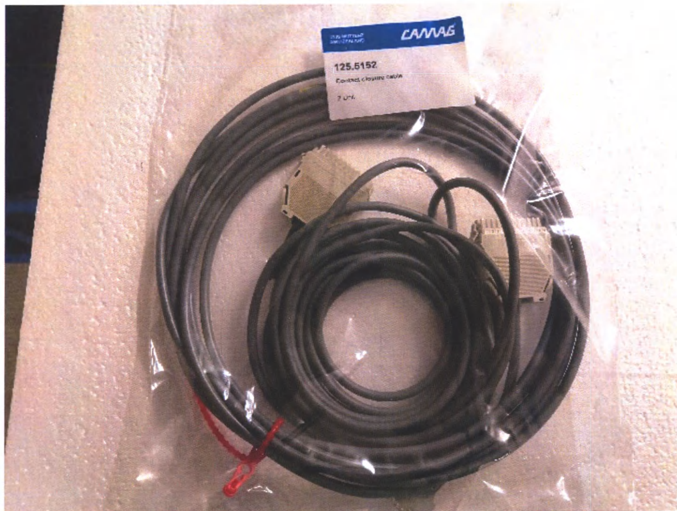
Фотографическое изображение 16 – Кабель для подсоединения к ВЭЖХ-МС/МС системе
