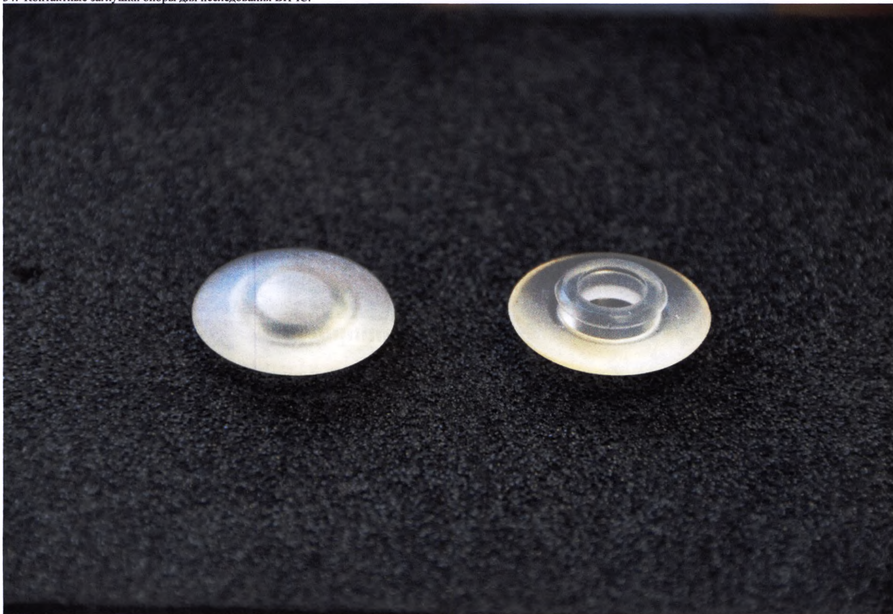
34. Контактные заглушки опоры для исследования ВНЧС.
