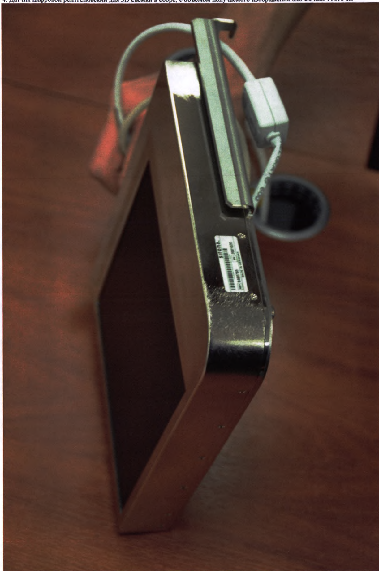
4. Датчик цифровой рентгеновский для 3D съемки в сборе, с объемом получаемого изображения 8х8 см или 11х10 см
